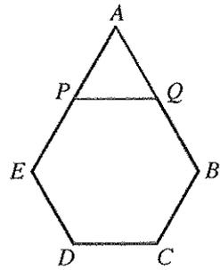
$B$  සන්ධියෙහි ප්‍රතික්‍රියාවේ තිරස් හා සිරස් සංරචක වන  $(X, Y)$  ද  $PQ$  සැහැල්ලු දණ්ඩේ තෙරපුම වන  $T$  ද නිර්ණය කිරීම සඳහා ප්‍රමාණවත් සමීකරණ ලියා දක්වන්න. ඒහයින්,  $B$  සන්ධියේ දී  $AB$  දණ්ඩ මත ප්‍රතික්‍රියාව සොයා,  $T = \frac{7W}{\sqrt{3}}$  බව පෙන්වන්න.
